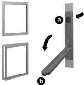
Bedarfsflügel (2) durch drücken der Entriegelungstaste (a) öffnen und den Hebel bis in Endstellung nach unten klappen (b; Öffnungswinkel ca. 135°). Das Fenster ist entriegelt; der Flügel kann komplett geöffnet werden.
