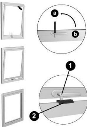
Griff nach oben (a) bewegen. Fenster ist entriegelt; der Flügel kann geöffnet werden.
