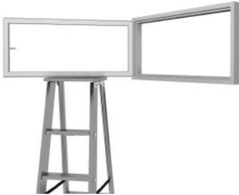
muss die Flügelast abgefangen werden (z.B. durch Stützbock oder Leiter). Zusatzlasten (z.B. Aufstützen oder Anhängen von Gegenständen) sind unbedingt zu vermeiden. Es besteht die Gefahr des Flügelabsturzes. Gekippt werden kann das Fenster auch von nicht unterwiesenen Personen.
