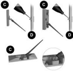
1. Schließbleche (C) an den Einlaufseiten mit technischer Vaseline oder einem anderen harz- und säurefreien Fett schmieren.
