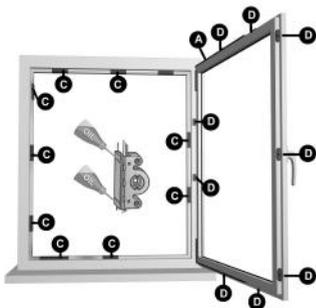
Die eingezeichneten Schmierstellen müssen mindestens einmal jährlich geschmiert werden, um die Leichtgängigkeit der Beschläge zu erhalten.
